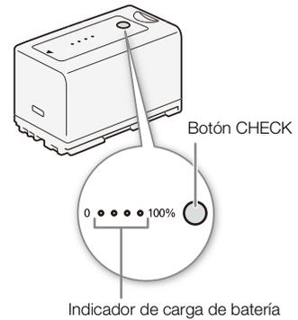
Pulse el botón BATT. INFO para visualizar la carga restante de la batería (se muestra durante 5 segundos). Dependiendo de la vida de la batería, es posible que la información de la batería no pueda ser visualizada.
