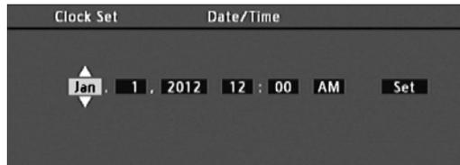
1 Mueva el joystick arriba/abajo o gire el selector SELECT para cambiar el mes/día y, a continuación, desplace (▶) hasta el siguiente campo.
