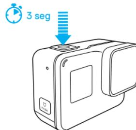
La cámara se enciende, emite varios pitidos y empieza automáticamente a capturar fotos secuenciales. Las luces de estado de la cámara parpadean cada vez que se captura una foto.
