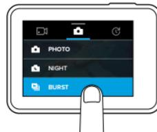
4. En la pantalla principal, toque la configuración que desee cambiar.
