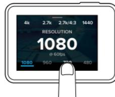
Si selecciona una resolución de vídeo (RES) que no soporta los fotogramas por segundo (fps) elegidos, aparecerá un mensaje para que toque la pantalla táctil y cambie automáticamente la configuración de FPS a un valor diferente. Si selecciona una velocidad FPS no soportada por la resolución elegida, aparecerá un mensaje similar.
