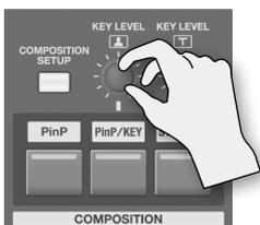
\* Girar esta perilla cambia también el valor del ajuste de extracción Key Level en la pantalla de ajustes de PinP/KEY.
