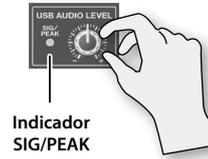
Para comprobar el nivel de volumen de audio USB siendo emitido, puedes usar el medidor de nivel que aparece en la pantalla USB Streaming, o el indicador de SIG/PEAK en el panel superior.
